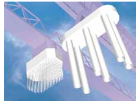
Paalfundering bestaande brug en buispaalfundering nieuwe brug
