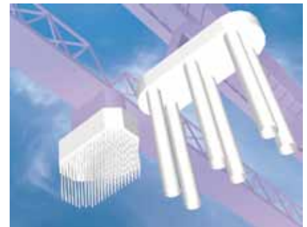
Paalfundering bestaande brug en buispaalfundering nieuwe brug
