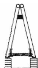
Verstijfde staafboog met vollewandligger als verstijvingsligger
