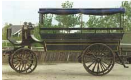
Dit type grote brik kwam in het midden van de vorige eeuw veel voor. Het is een wagen met tamelijk brede velgen en voorzien van vetassen.
