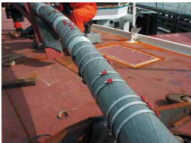
De hangkabel: een full locked cable (foto: Bart Spaargaren)
