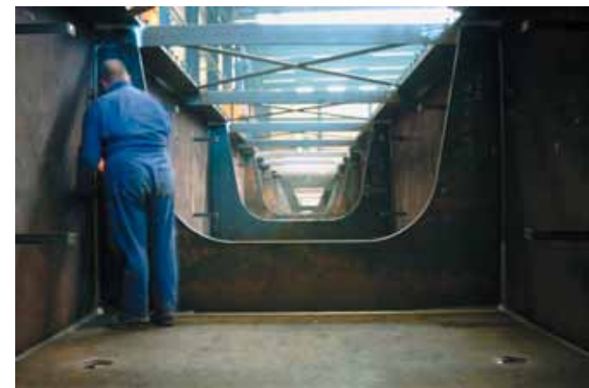
Doorsnede stalen onderconstructie tijdens de fabricage.
