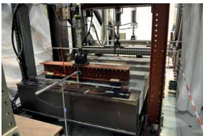
8 Proefstuk en opstelling vermoeiingsproef beelden: WMC/FiberCore Europe
