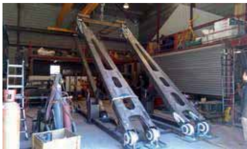
Het hefsysteem in de werkplaats
