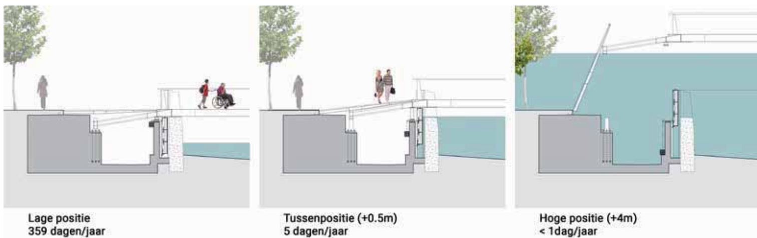
Drie Brugposities en positie afdichtingsschot op linkeroever
