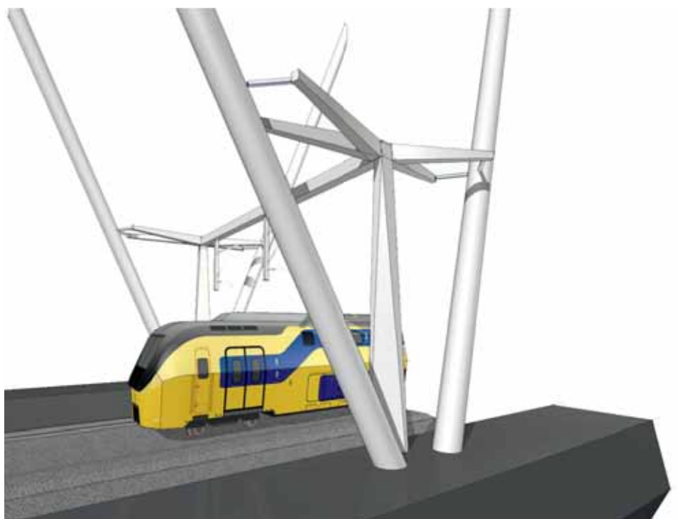
12 Ophangconstructie dempers geïntegreerd met bovenleidingsportalen
