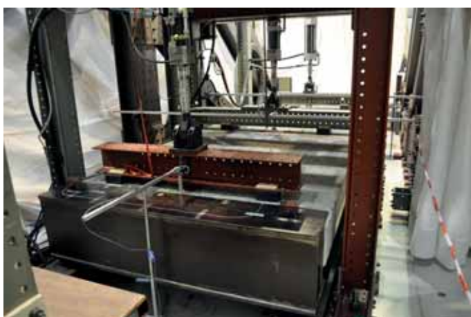
8 Proefstuk en opstelling vermoeiingsproef beelden: WMC/FiberCore Europe
