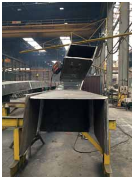
18 Boog en langligger zijn samengestelde kokerliggers
