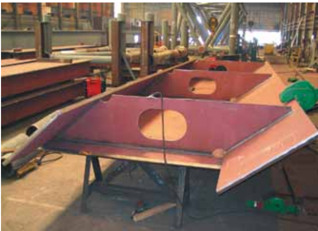
Aflassen geboorte koker dwarsdrager.
