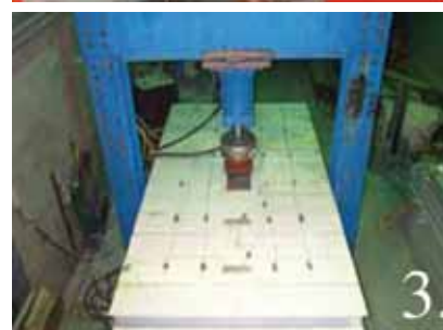
15. 1. Duraspan buigproef bij belastingafdracht in dwarsrichting 2. Onderzoek naar de vermoeiingssterkte 3. Onderzoek naar effectieve breedte bij lokale astinleiding (belasting uit wielprint) 4. Onderzoek naar dynamisch gedrag (frequentiegedrag) http://www.creativepultrusions.com/LitLibrary/products/superdeck/
