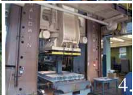
15. 1. Duraspan buigproef bij belastingafdracht in dwarsrichting 2. Onderzoek naar de vermoeiingssterkte 3. Onderzoek naar effectieve breedte bij lokale astinleiding (belasting uit wielprint) 4. Onderzoek naar dynamisch gedrag (frequentiegedrag) http://www.creativepultrusions.com/LitLibrary/products/superdeck/
