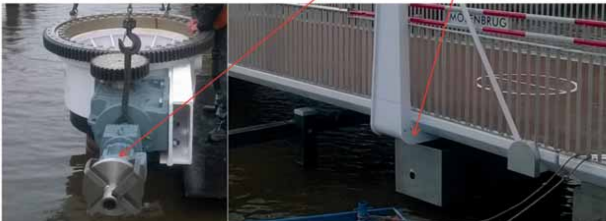
Motor 1.5 kW Handbediening op achtereinde draaistroommotor Vliegwiël op achterzijde draaistroommotor
