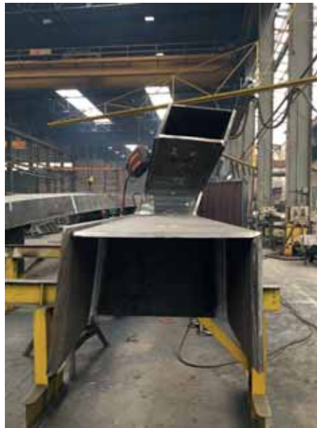
18 Boog en langsligger zijn samengestelde kokerliggers
