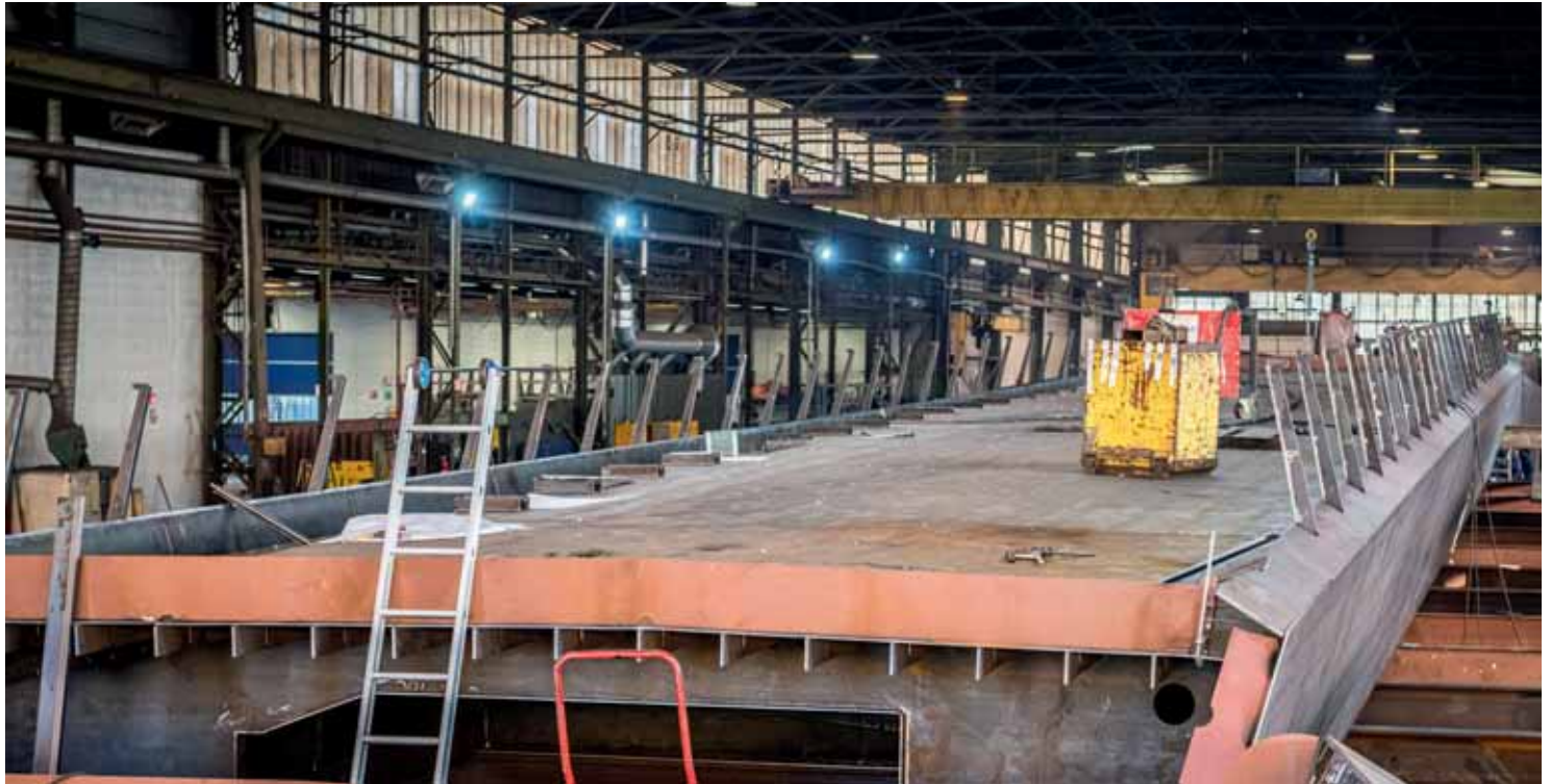
↓ 8 Kokerligger in constructiehal ©Fotografie Arie Mastenbroek, Zaltbommel.
