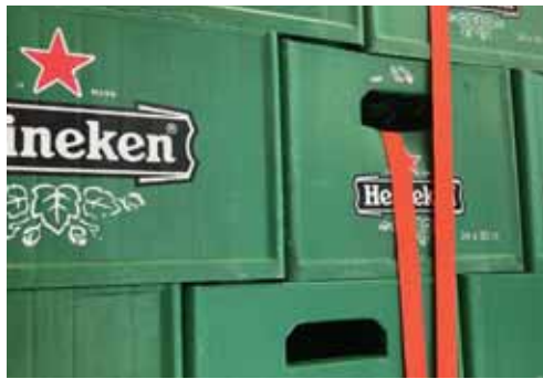
Vervorming door temperatuursverhoging
