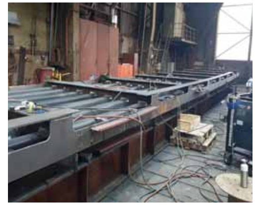
25 Laswerk van het nieuwe stalen troglijggerdek © Gebr. Beentjes GWW, 2019
