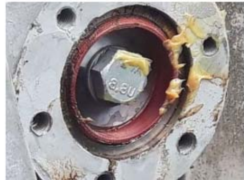
Figuur 18 Zijaanzicht met duidelijk de verschuiving in de lager zichtbaar
